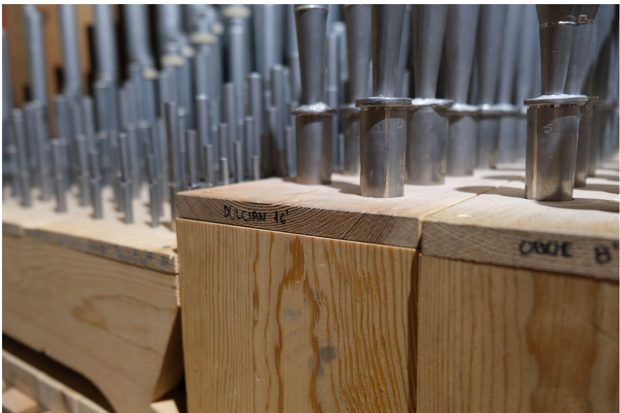
Secretos y tubos del registro Dulcian 16'
